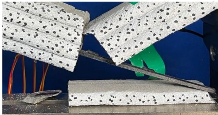
混凝土打印层间剥落
